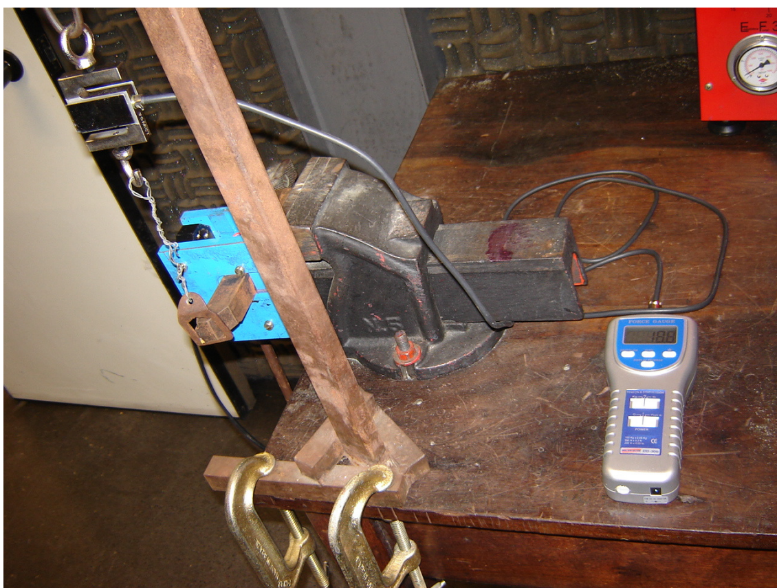
Figura 24. Bancada e dinamômetros usados na calibração do dispositivo.
